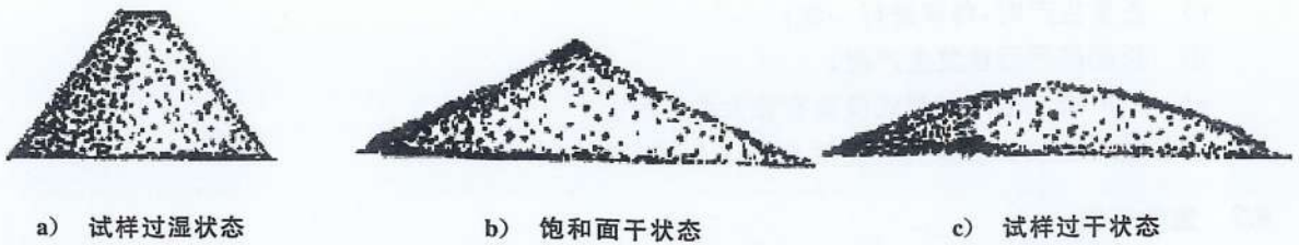
图4 天然砂饱和面干状态示意图
