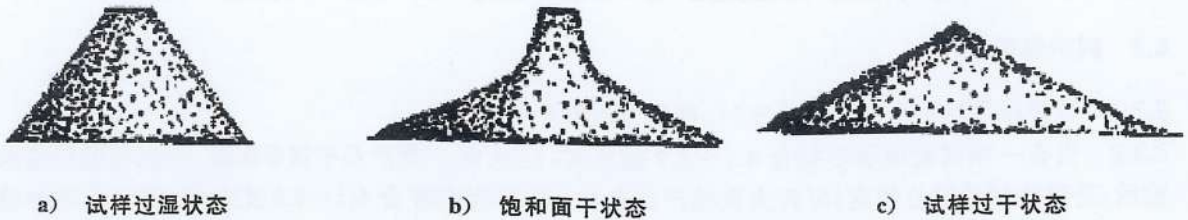
图5 机制砂饱和面干状态示意图
